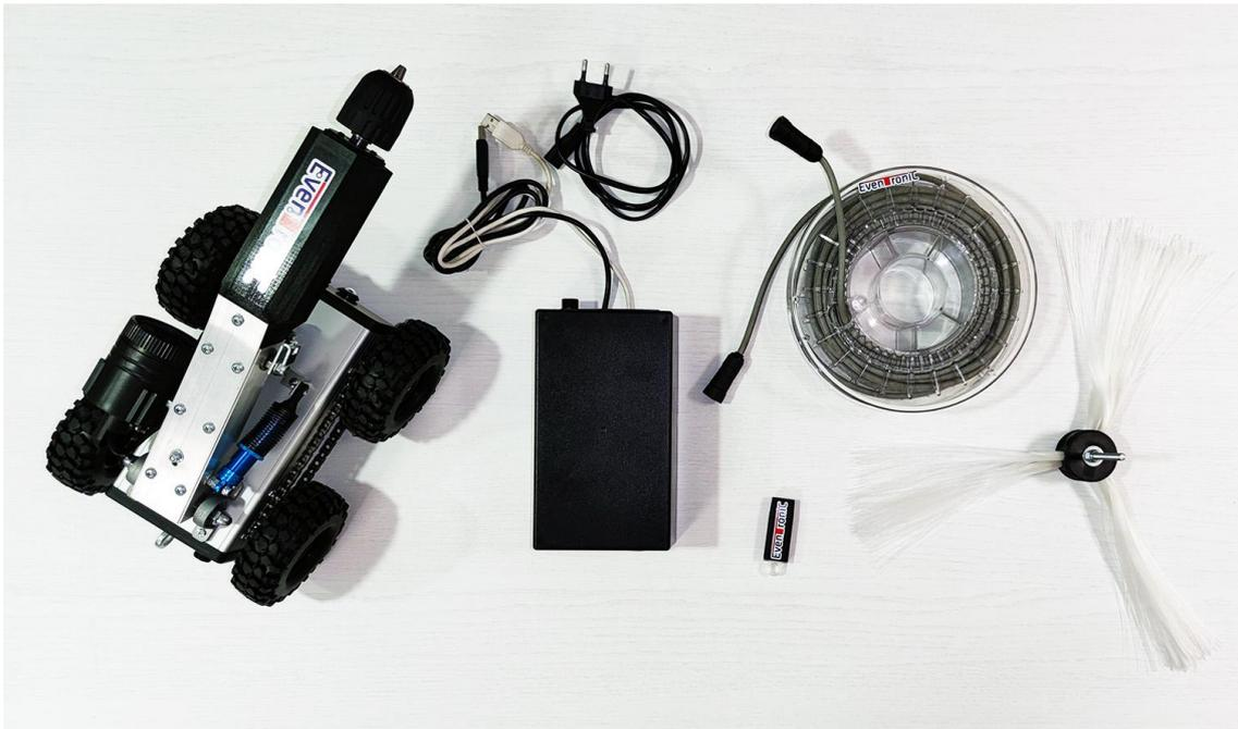
De izquierda a derecha, tenemos al robot Eventronic EVClean-XL, la “caja negra” que es la fuente de alimentación y datos, la cual contiene una toma de corriente de 220V y dos salidas USB para el ordenador. En su parte frontal tiene el botón de encendido y apagado. También dispone de un cable de alimentación para toma europea de 220V corriente alterna monofásica.
